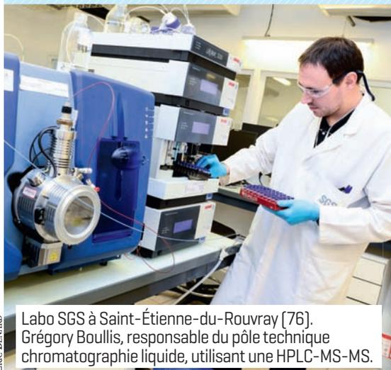
Labo SGS à Saint-Étienne-du-Rouvray (76). Grégory Boullis, responsable du pôle technique chromatographie liquide, utilisant une HPLC-MS-MS.
